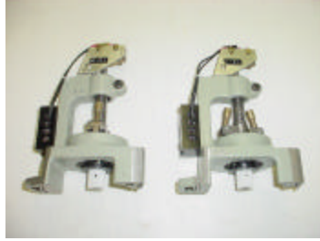
Aux. Speed Switches
